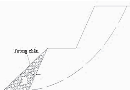
Hình 7. Bảo vệ bờ mỏ bằng tường chắn ở chân mái dốc
